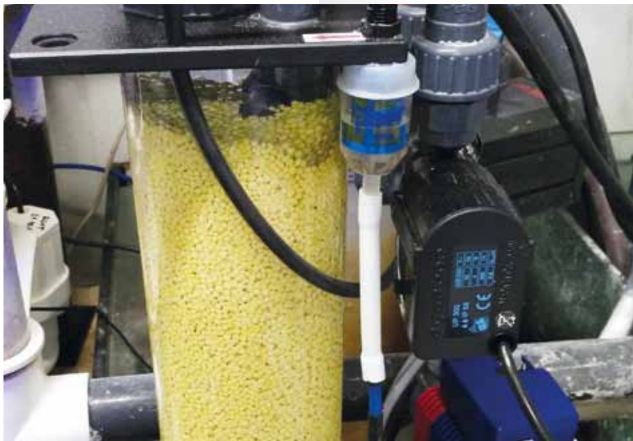
Denitrifikační sírový filtr v akváriu na vstupu /Denitrification sulphuric filter in the aquarium at the entrance/
